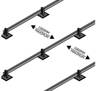
BUILDING THE SUPPORT JOIST GRID. RUNNING IN THE OPPOSITE DIRECTION TO YOUR SUPPORT BEARERS, ONE ADDS THE JOISTS.
